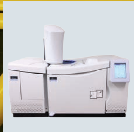
Oplosmiddel analyse met gaschromatograaf/massaspectrometer
