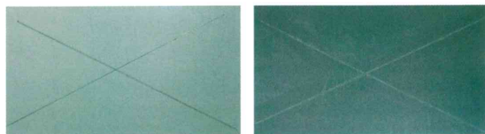
Aluminium plaatjes 1000 uur zoutsproeitest
